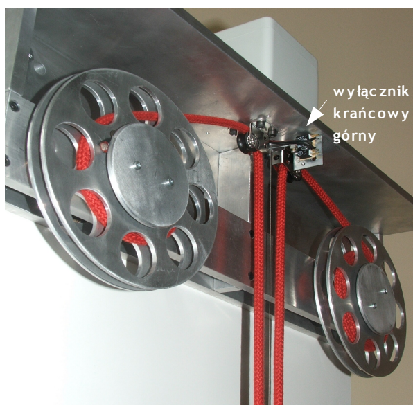
Rys 5. Umiejscowienie wyłącznika krańcowego górnego (z lewej) oraz dolnego (z prawej)
