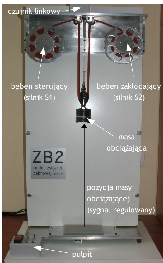
Rys 1. Widok ogólny modelu zwijarki bębnowej ZB2
